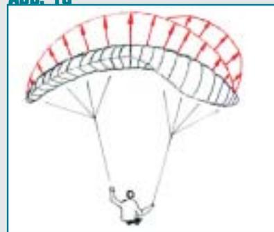
Zieht der Pilot an der Steuerleine, werden gleichzeitig Auftrieb und Widerstand erhöht
